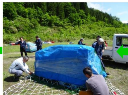
荷崩れしないようにブルーシート、巨大ラップ、緑ネット、モッコで荷物を包む
