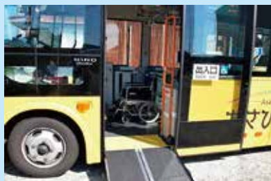
▲乗車用スロープと車椅子用スペース
