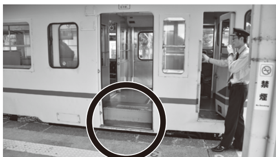
JR 泊駅（写真左）と越中宮崎駅（同右）のホームと車両乗降口の高さの違い。（現行車両で比較した場合） 新型車両（521系）になると、乗降口がさらに20センチ高くなるため、越中宮崎駅のホームのかさ上げが必要となる。
