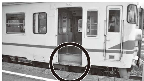
JR 泊駅（写真左）と越中宮崎駅（同右）のホームと車両乗降口の高さの違い。（現行車両で比較した場合） 新型車両（521系）になると、乗降口がさらに20センチ高くなるため、越中宮崎駅のホームのかさ上げが必要となる。
