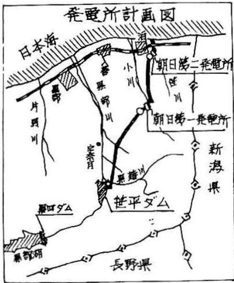
第一第二発電所の建設を計画したも 足を来していたが、朝日計画により のである。朝日計画により出現する 黒四ダムの水系一貫運用が可能とな 笹平ダムは逆調整池としての役割を り、笹平ダムの調整能力を一体化し 果すので、黒四ダムの流況改善の効 て用水不足が一段と緩和する。 果は一層高まり、黒部川の流況は安 (2)かんがい用水の取水調整が容易に 定すると共に、扇状地の用水は更に なる。
